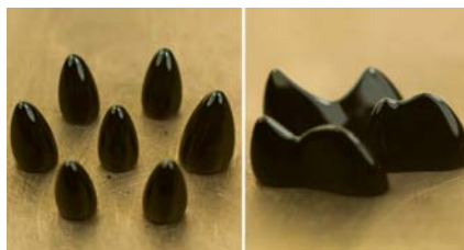
توده‌ای از فروشاره تحت تاثیر یک میدان مغناطیسی می‌تواند به اجزای کوچکتر تقسیم شود و خود را به قطرات ساده آرایش دهد (شکل سمت چپ)، و یا به آرایش‌های پیچیده (شکل سمت راست).
